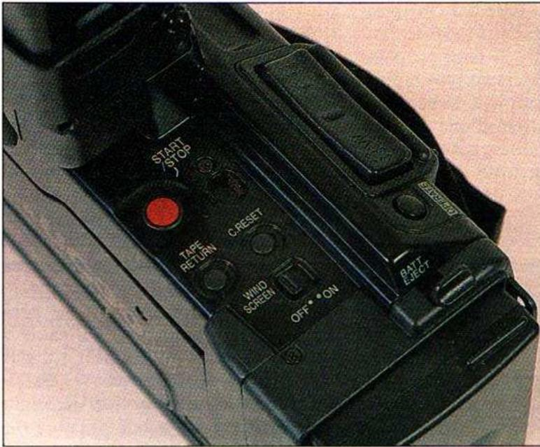
Une touche rouge double le déclencheur, un commutateur met en service un filtre anti-vent ; on commande ici le retour au zéro du compteur et le retour de bande pour visualiser la fin d'une prise de vues.
