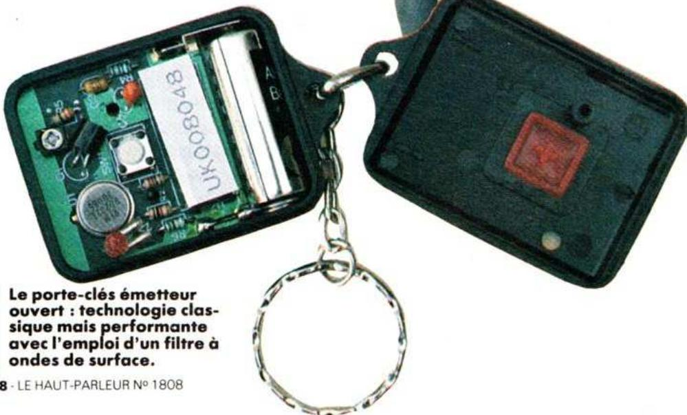
Le porte-clés émetteur ouvert : technologie classique mais performante avec l'emploi d'un filtre à ondes de surface.
