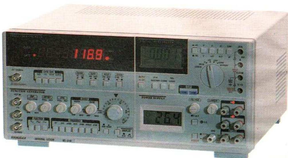
secteur et ses fusibles, toutes les commandes sont placées en face avant. Celle-ci est divisée en quatre zones bien distinctes correspondant chacune à une fonction de l'appareil : fréquencemètre, générateur de fonctions, multimètre et alimentation stabilisée.
