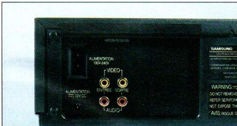
Connectique arrière : deux prises pour l'alimentation, celle en 12 V n'est pas courante. Pas de prise Scart, on utilise ici des RCA. Pas de commutation automatique du téléviseur par conséquent.
