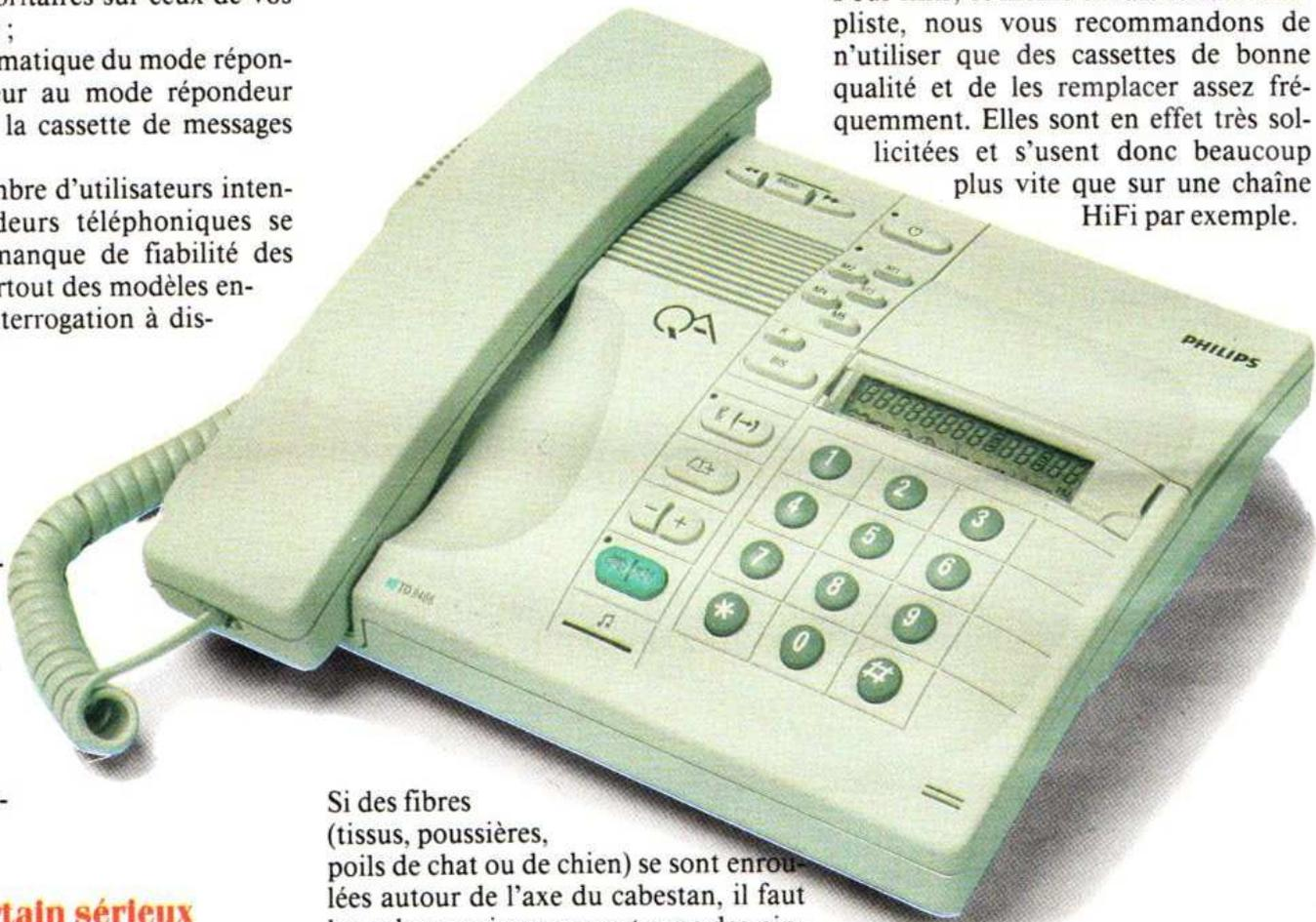
**En plus des caractéristiques du modèle précédent, le TD 9466 dispose d'un affichage à cristaux liquides : heure/date, numéro appelé ou en mémoire, nombre de messages avec horodatage.**
