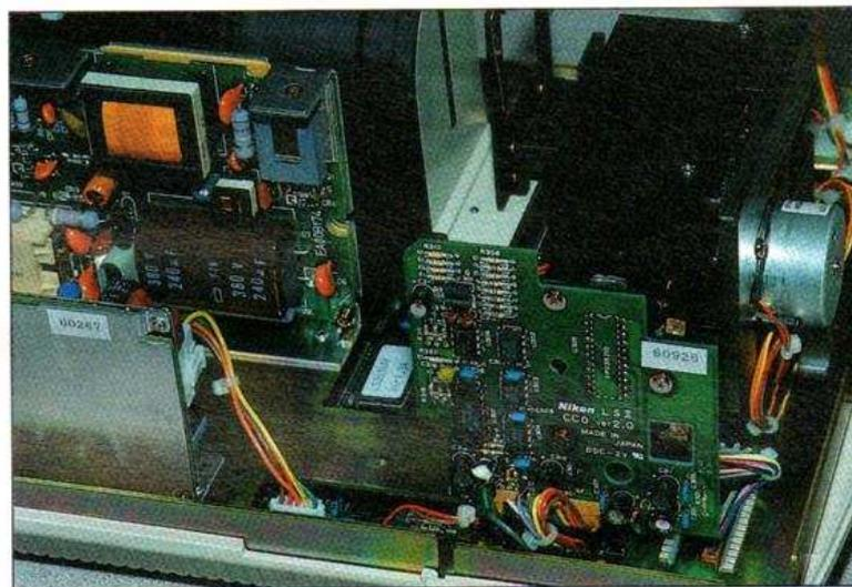
La barrette CCD est installée sur ce circuit imprimé. Sur la droite, le moteur pas à pas sert à déplacer le chariot supportant l'objectif, il assure la mise au point de l'image sur le capteur.
