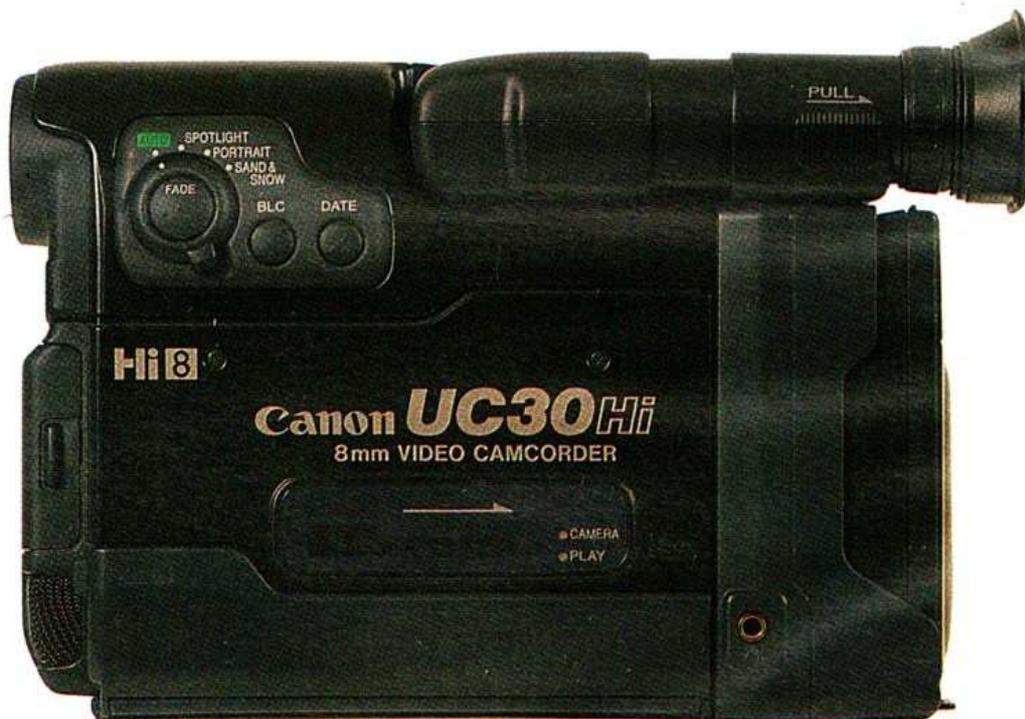
L'UC 30 Hi est un caméscope Hi 8 très plat qui se sangle à la main droite et s'oublie. Son objectif – fait rarissime – vient dans le prolongement du viseur : on appréciera cette option lors d'une prise de vues rapprochée. Pour la mise au point, on tire le viseur vers l'arrière et on le bascule vers le haut. Une fois levé, il laisse apparaître un premier tableau de commande.
