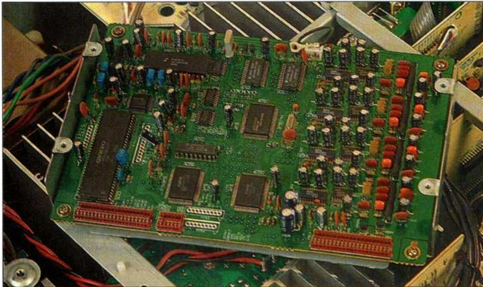
La carte numérique accueille le microcontrôleur de gestion de l'ampli-tuner, on y trouve surtout les éléments de traitement numérique du son : Dolby Pro-Logic, ambiance, etc. Sur la droite de la platine, quatre signaux sont disponibles au travers de filtres et convertisseurs NA.
