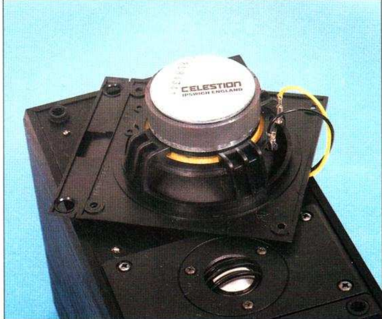
Le haut-parleur de grave de l'enceinte Celestion 1 fournie pour la reproduction de l'ambiance : son saladier est moulé dans une matière plastique et reste solidaire de la face avant de l'enceinte.
