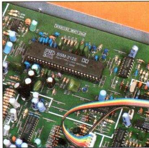
Un très gros circuit intégré se charge du traitement Dolby Pro-Logic. Analogique, il associe amplis opérationnels et VCA, amplificateurs à gain commandé en tension.
