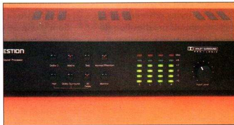
La face avant reçoit une série d'indicateurs de niveau que l'on utilise dans la phase de mise en service et pour détecter les messages codés Dolby. Les touches modifient le mode d'exploitation.
