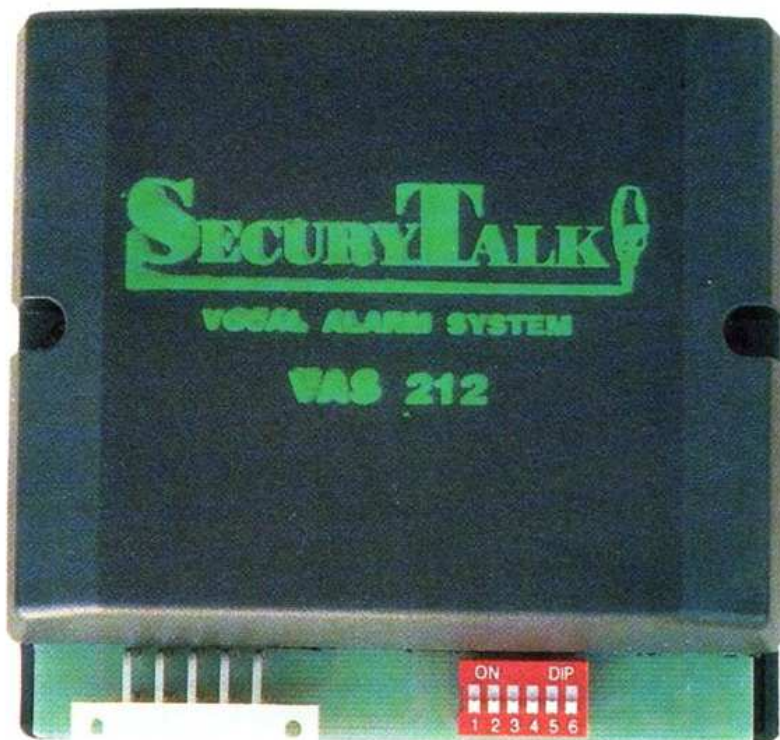
Le boîtier principal du Securytalk avec les mini-interrupteurs de configuration.
