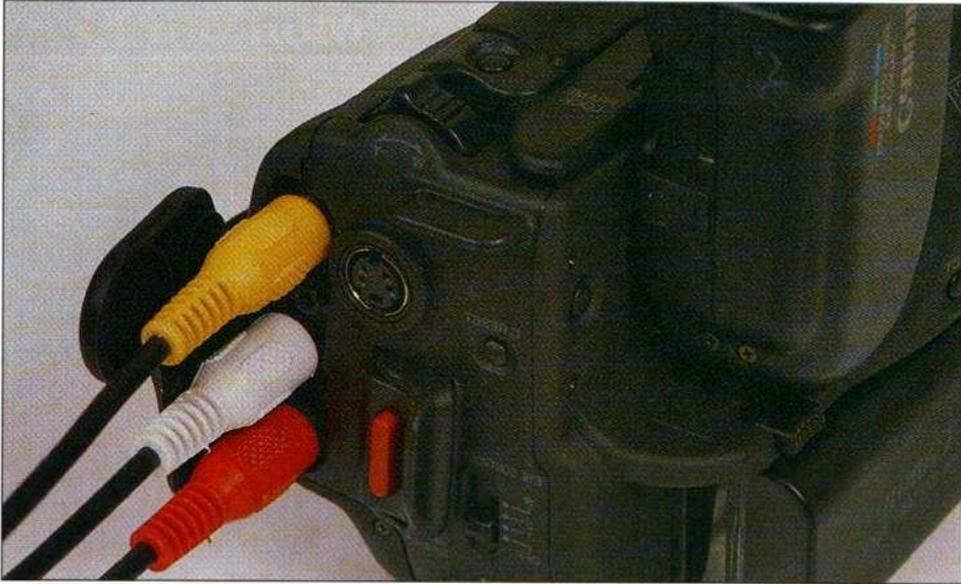
Des commandes réparties un peu partout à la surface du caméscope. Les sorties par RCA s'accompagnent d'une S-Vidéo à utiliser impérativement !
