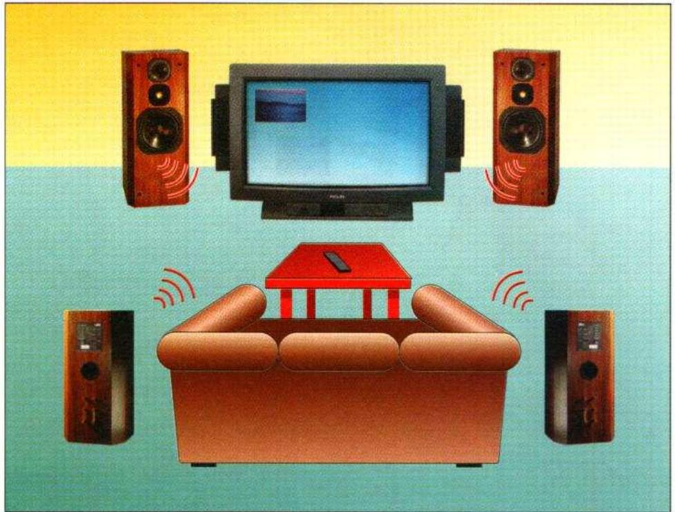
L'installation Dolby Surround a besoin de deux enceintes principales et de deux secondaires alimentées par le même amplificateur.
