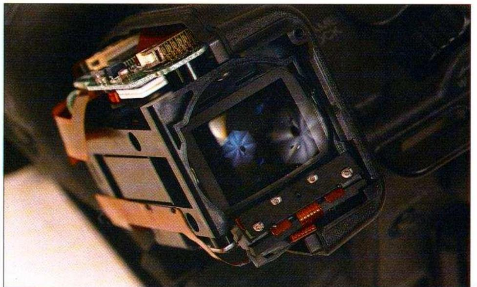
Dans le bas du viseur, quatre diodes envoient leurs signaux vers l'avant de l'œil dont on détecte la position par un capteur CCD installé à l'intérieur du viseur.
