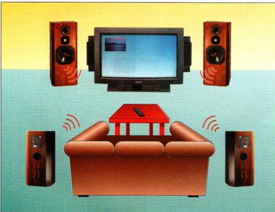
Avec quatre enceintes, vous utiliserez le mode fantôme dans lequel le signal mono normalement destiné à l'enceinte centrale est réparti entre les enceintes gauche et droite.
