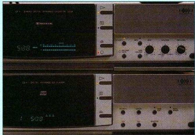
Des commandes secondaires sont cachées derrière des volets. chaque appareil a un afficheur correspondant à sa fonction, plages pour le lecteur de CD, niveau pour le magnétophone.
