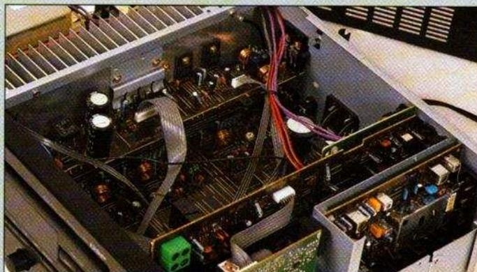
Un seul radiateur reçoit tous les composants ; en haut, les circuits intégrés des canaux arrière ; en bas, les transistors discrets des autres amplificateurs. Décodeur, tuner et préampli sont sur des cartes perpendiculaires.
