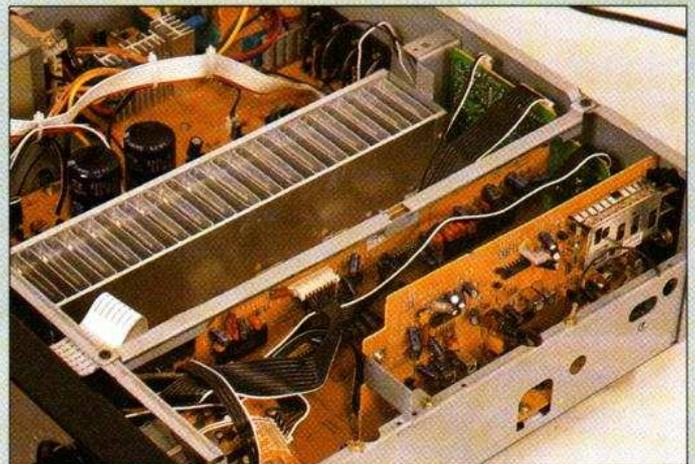
Organisation générale de l'appareil : module du tuner, module d'entrée et de traitement « Dolby » et, derrière, le radiateur des amplificateurs. Simple plaque pour les voies arrière, ailettes en accordéon pour la gauche et la droite.
