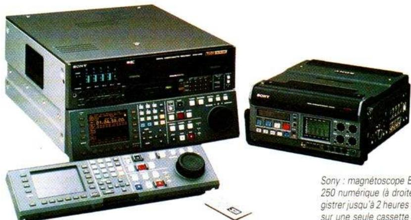
Sony : magnétoscope Betacam DVW-250 numérique (à droite) ; il peut enregistrer jusqu'à 2 heures de programmes sur une seule cassette et une seule et même batterie.
