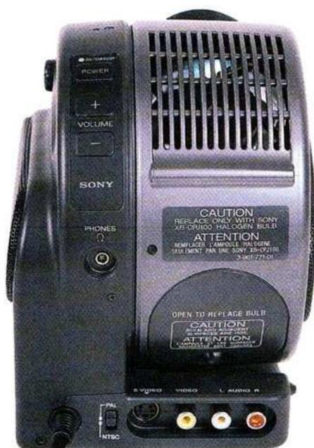
L'arrière du projecteur vidéo avec en bas les prises entrées audio/vidéo et S-Vidéo, à gauche la prise casque et les touches de commande de volume.
