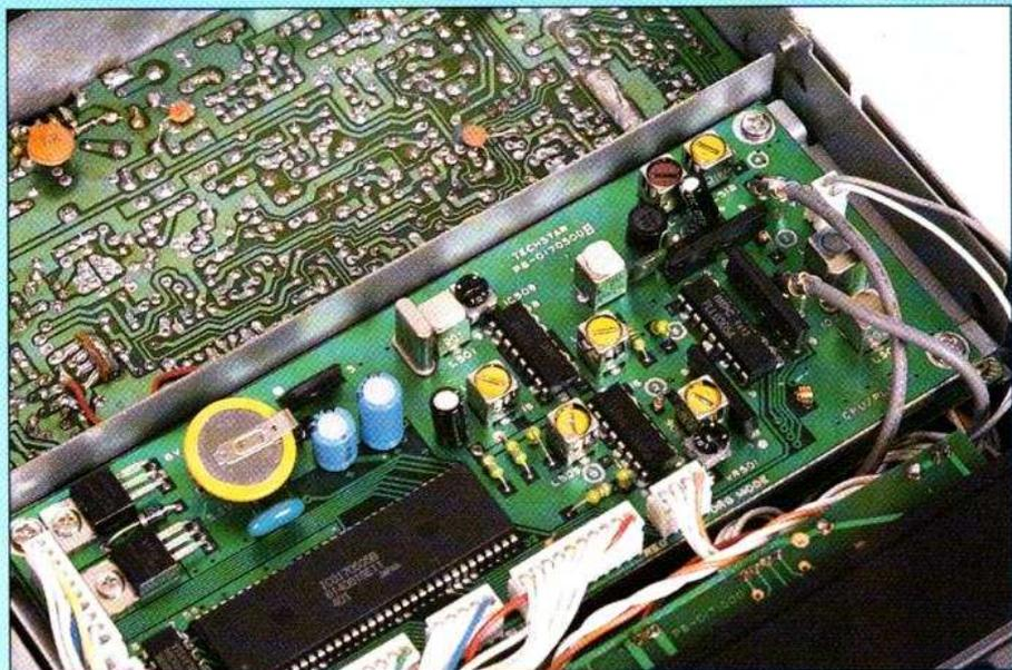
Un circuit imprimé à double face et trous métallisés reçoit le microcontrôleur de gestion et les composants de la PLL.
