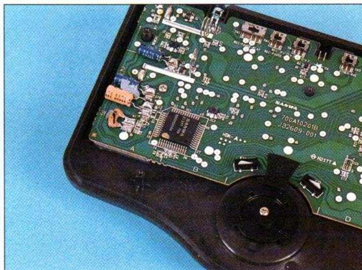
Au cœur de la télécommande de montage se trouve un circuit intégré signé Sanwa, comme le circuit imprimé. Il intègre les mémoires ROM des codes et une SRAM pour le stockage des ordres appris.
