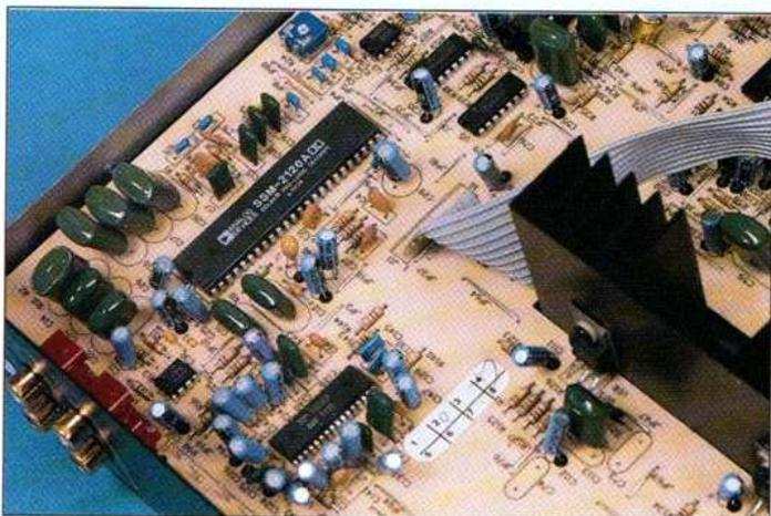
L'unité centrale renferme un décodeur analogique SSM 2126A. Devant, nous avons le circuit intégré « BBE » fabriqué par Exar. Les amplificateurs de puissance sont des circuits intégrés bien connus.
