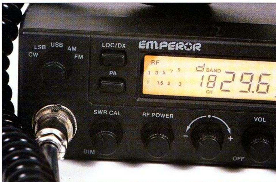
Au-dessus de la prise micro à 5 broches (le micro dispose de deux touches d'accord), un commutateur sélectionne le type de modulation. Il n'y a pas de réglage de gain RF mais une position local/distance qui réduit les signaux forts.
