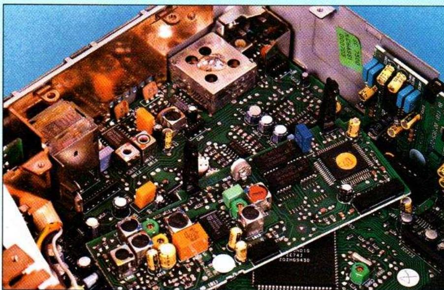
Vue intérieure de l'autoradio Grundig 7500 RDS. La carte démontée ici supporte les mémoires des informations routières et le processeur qui les gère. Elle reçoit aussi les composants du tuner MA. Grundig réalise son tuner, les techniques de montage en surface sont omniprésentes.
