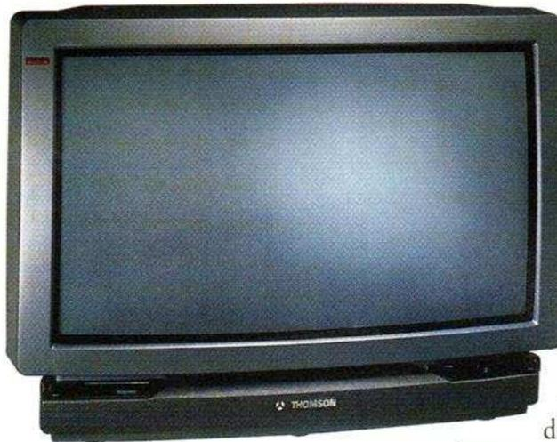
**E**n face AV, on dispose d'une connectique plus particulièrement destinée au raccordement d'un camescope (composite ou Y/C). Cette connectique permet l'utilisation de deux décodeurs, chose assez rare pour être signalée. La télécommande agit aussi sur les magnétoscopes de la marque. Moyennant programmation, il est possible de lui faire commander des terminaux Eurocrypt, Videocrypt, Visiopass et DecSat, ce qui est bien pratique.
