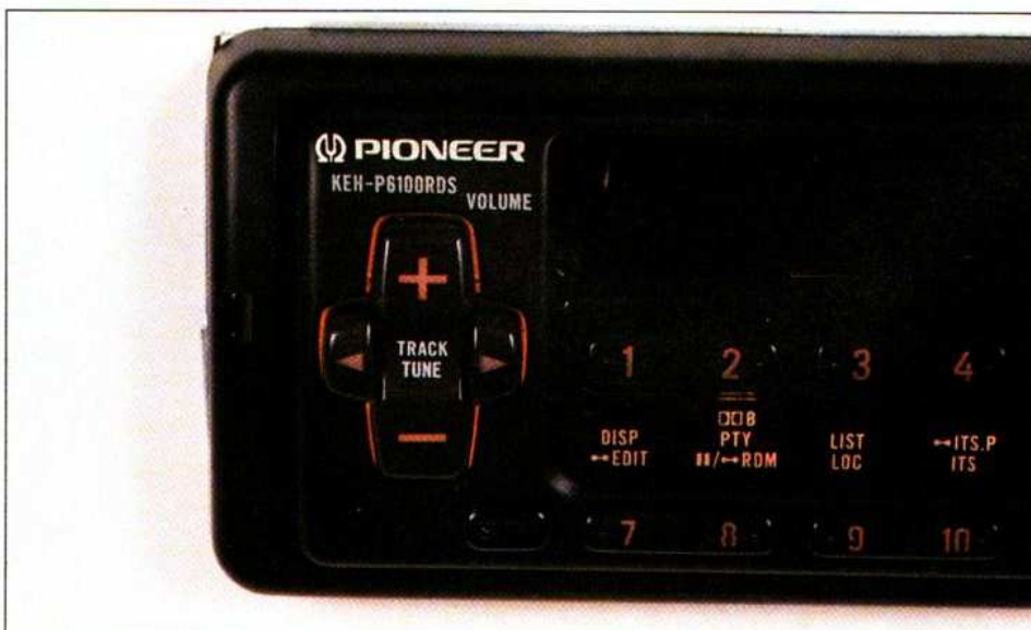
Sur la gauche de la façade, une touche en croix assure divers réglages. Ici, on a choisi un affichage orange.
