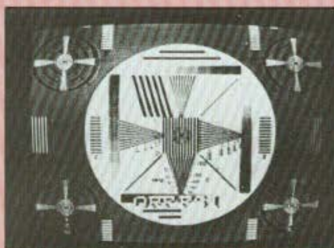
Autriche ORF-FS1 (1982). Mire monochrome de contrôle et d'identification de la 1ère chaîne TV autrichienne. Canal : E2. Bande 1VHF. Emetteur : Javerling. Puissance : 60 kW PAR.
