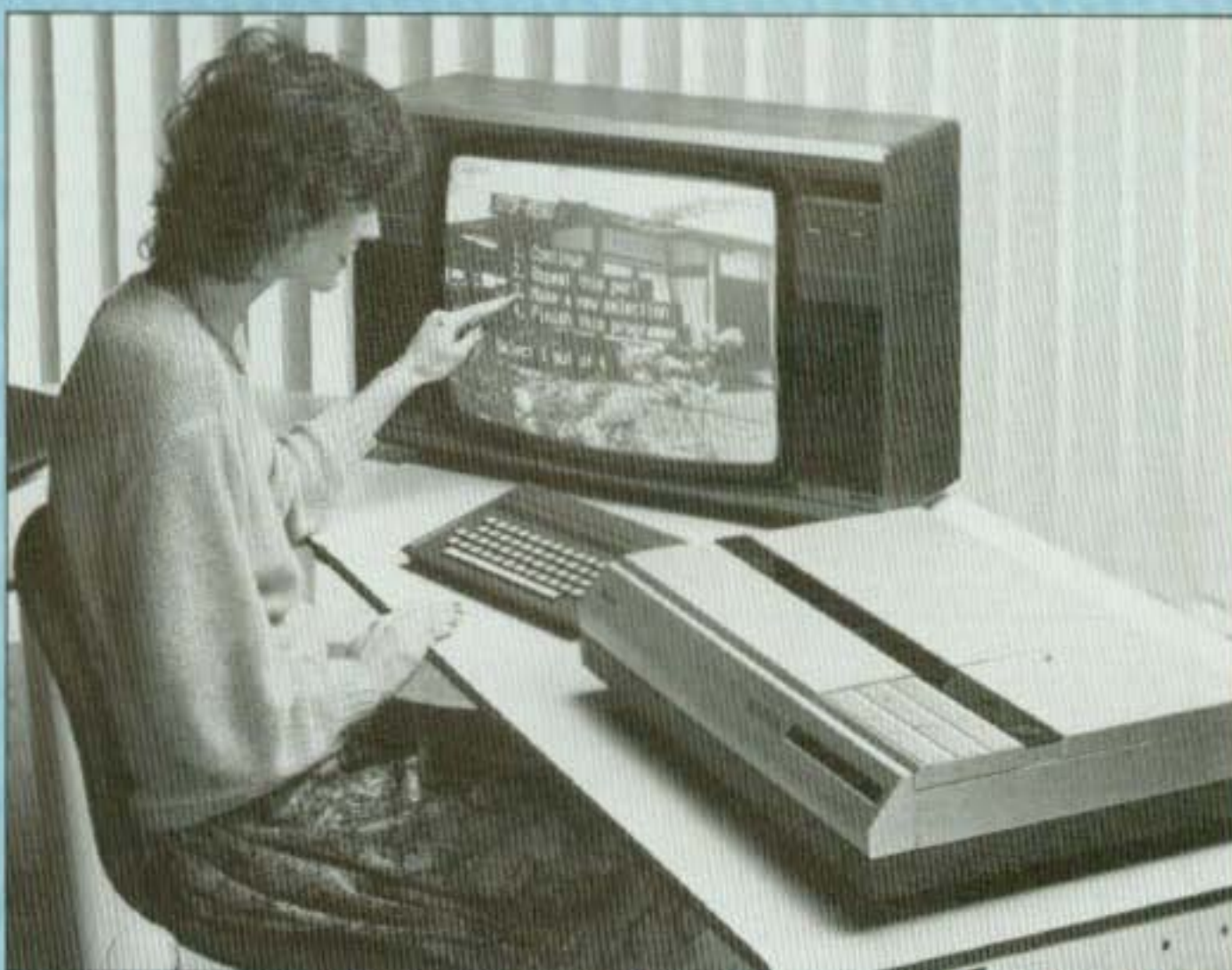
Fig. 8 : Le vidéo-disque LaserVision interactif associé à un moniteur TV du type « Touch Screen » et à un clavier d'entrée alphanumérique.
