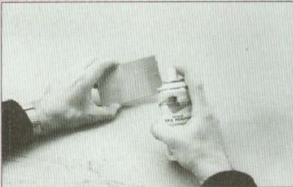
Présensibilisation de la surface du circuit imprimé.
