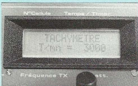
Ecran du tachymètre. Sonde tournée vers ampoule secteur donc 50 x 60 = 3 000 tr/mn.
