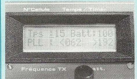
Ecran buzzer pour alarmes. Temps à 15 mn. Batterie à 10 V. Seuils PLL pour HF8.
