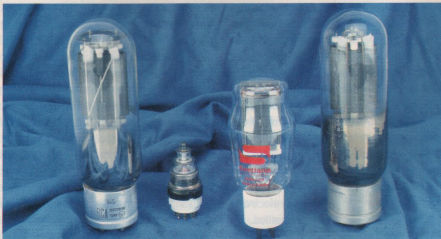
Figure 3 : la 2C40, la 211/VT4C, la 811, et dans une moindre mesure la 845 sont des triodes de puissance pouvant fonctionner avec des tensions de grille positives, ce fonctionnement leur assure une linéarité remarquable au détriment de la puissance demandée à la source ; c'est pour cette raison que l'on pilote souvent ces tubes par des tubes de petite puissance. La 845 et la 811 sont toujours fabriquées de nos jours.
