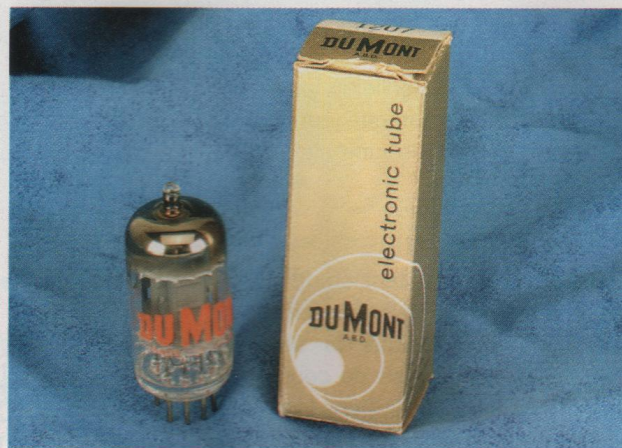
Figure 5 : tube 12U7. Ce tube qui ressemble comme deux gouttes d'eau à une vulgaire 12AU7 a partout une particularité remarquable : il est prévu pour fonctionner avec une haute tension de 12 V sur son anode. La 12U7 était employée comme préamplificatrice BF dans les autoradios à tubes des années 50. Son coefficient d'amplification est un honnête «20», pour un courant de 1 mA, sa pente est de 1,6 mA/V et sa résistance interne de 12,6 kΩ... Pas de quoi épuiser la batterie !...
