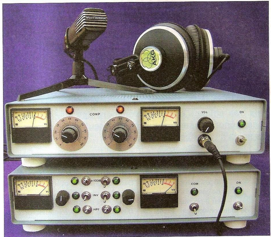
Ensemble de prise de son Préamplificateur pour micro à deux canaux couplé à un amplificateur de ligne
