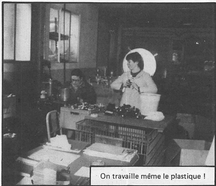
Ici, on perce en série le support des brins d'antennes.
