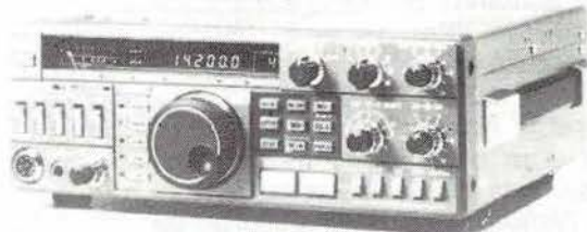
Emetteur-récepteur TS 430 SP* Tout transistor. LSB/USB/CW/AM et FM en option. 100 W HF. Emission bandes amateur. Réception couverture générale 12 volts.
