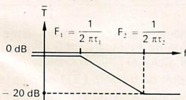
Filtre passe-bas employé dans cette étude ( $R_1 = 15 \text{ k}\Omega$ ;  $R_2 = 1,5 \text{ k}\Omega$ ;  $C = 40 \text{ nF}$ )
