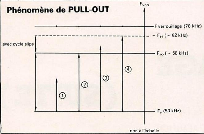
Partant d'une boucle verrouillée sur  $F_0$  à  $t = 0$ , il peut y avoir verrouillage sur un échelon d'entrée  $F_i$  sans cycle slip si  $F_i < F_{PO}$ , ou avec cycles slips dans une certaine zone contiguë à  $F_{PO}$ .
