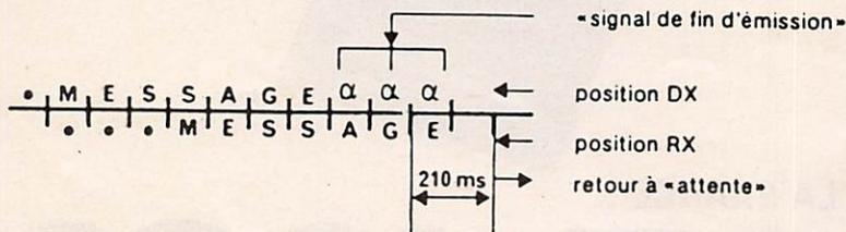
Voir également l'annexe représentant l'émission d'un message (de la mise en phase jusqu'aux signaux de fin de transmission).
