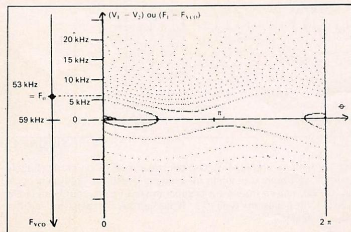
Plan de phase correspondant à  $F_1 = 59 \text{ kHz}$
