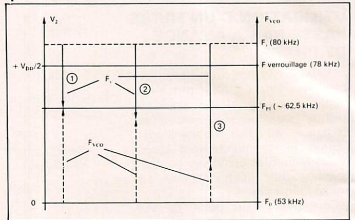
Note : Le signal de modulation a un coefficient de modulation de 9 kHz/V ; le signal de sortie de la boucle  $V_2$  a un coefficient de démodulation de 6,5 kHz/V.
