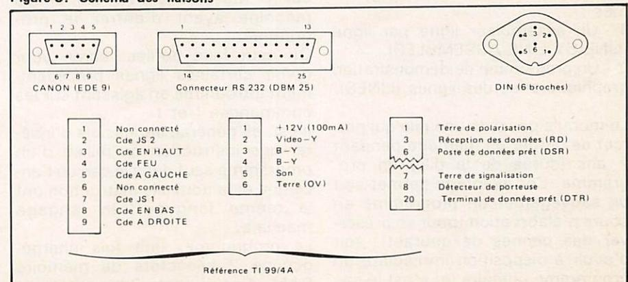
Figure 4 : Schéma de brochage des connecteurs
