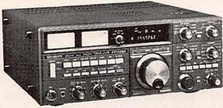
FT-726R Émetteur/Récepteur multibande VHF/UHF équipé de modules enfichables pour les bandes 144 MHz et 430 MHz. CW - BLU et FM. 10 W sur les 2 bandes.
