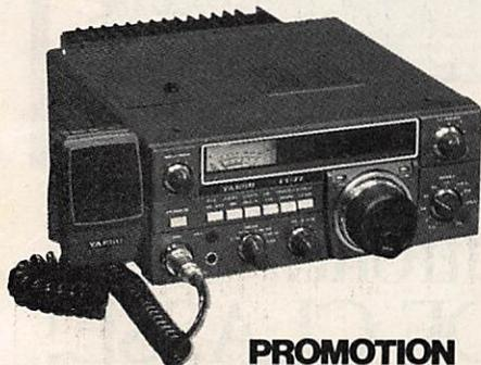
**FT 77** – Emetteur / récepteur mobile bandes décimétriques amateurs, 12 V DC. 2 versions: 10 W / 100 W.
