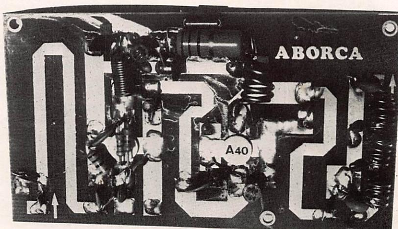
posante HF du courant continu, on doit trouver un gain d'environ 10 DB pour ce premier étage.
