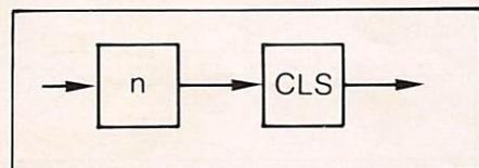
Cette instruction va permettre d'effacer l'écran, positionne le pointeur à sa place initiale, mais ne remet pas les mémoires à zéro.
