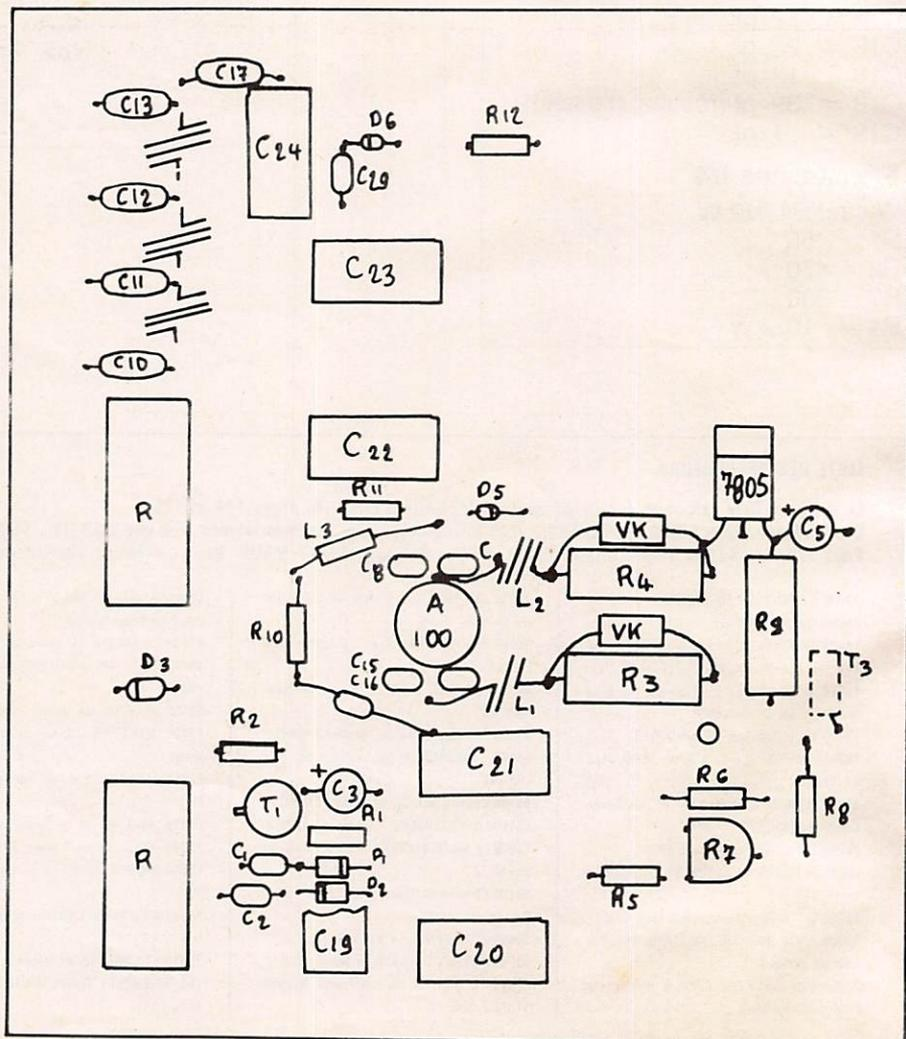
T.O.S. En B.L.U., on optimisera tout simplement avec R7 pour un signal de sortie correct et une polarisation minimum.
