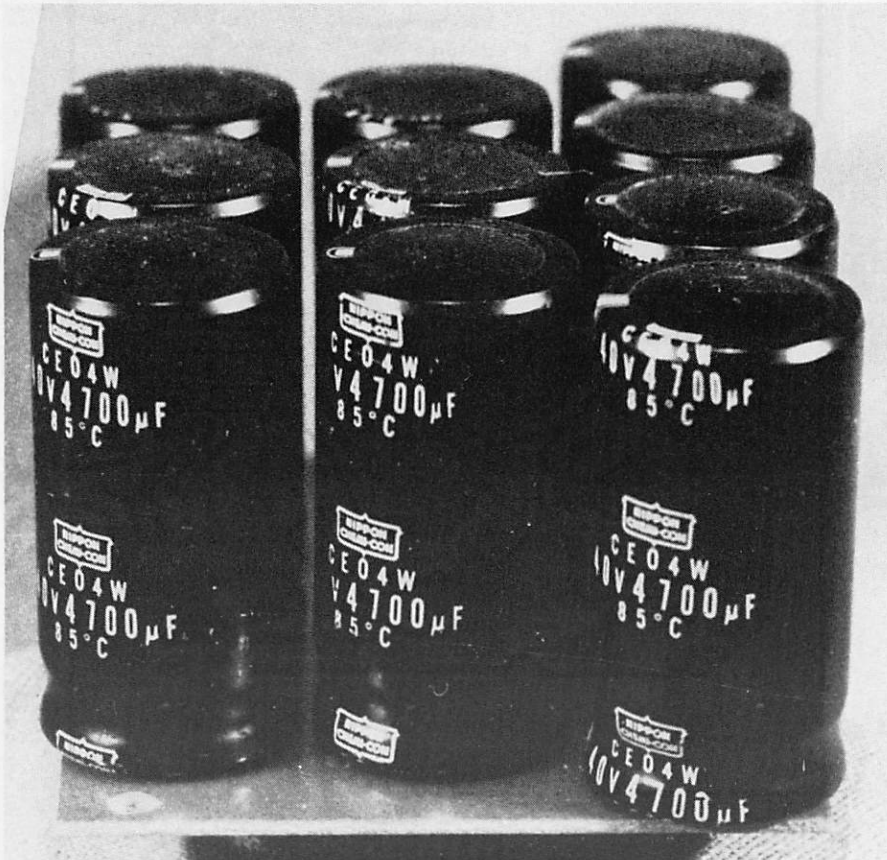
Utilisation des condensateurs 4 700 µF.
