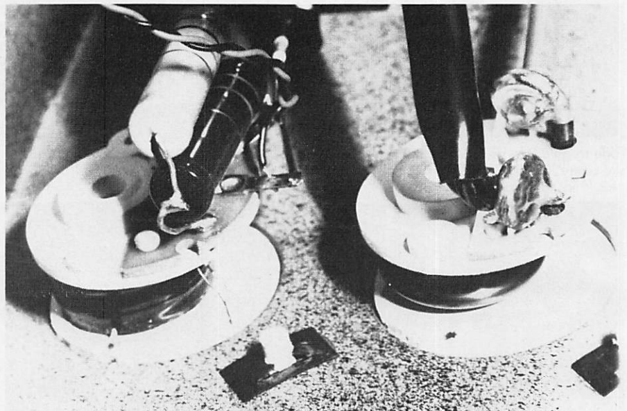
Détail des branchements sur les vu-mètres.
