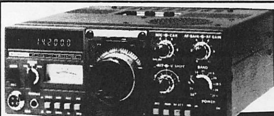
Emetteur-récepteur TS 130 SE prix 7179,00 Frs Tout transistor USB/LSB/CW/FSK 100 W HF CW 200 W PEP 3,5 - 7 - 14 - 18 - 21 - 24,5 - 28 MHz, 12 volts.
