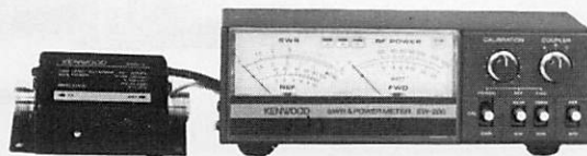
SW 200 Un wattmètre/Tos-mètre très précis, de 1,8 MHz à 450 MHz, permettant de contrôler simultanément 3 émetteurs et leurs antennes (voir schéma ci-dessous).
