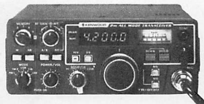
Emetteur-récepteur TR 9130 144 à 146 MHz. Tous modes. Puissance 25 W - HF.
