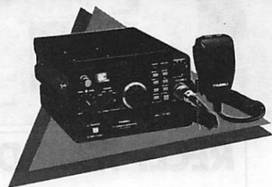
FT 290R Transceiver 144 MHz, tous modes, 2,5 W, accus et 13,8 V
