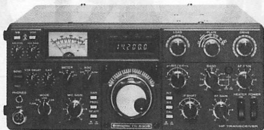
Émetteur-récepteur HF TS 530 S p Émission réception. Bandes amateurs. SSB/CW. Alimentation secteur incorporée.
