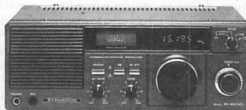
Récepteur R 600 Couverture générale 200 kHz à 30 MHz.
