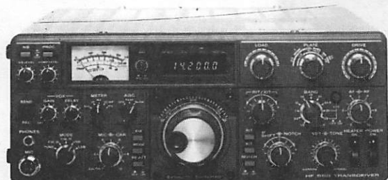
Emetteur-récepteur TS 830 S Emission-réception Bandes amateurs Tubes au final - 220 V - USB/LSB/CW.
