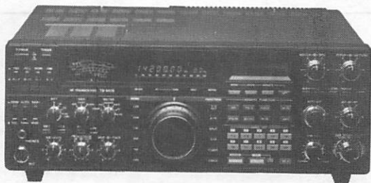
Emetteur-récepteur HF TS 940 SP* Emission-réception. Couverture générale. Tous modes. Alimentation secteur incorporée.
