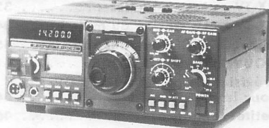
Emetteur-récepteur TS 130 SE Tout transistor. USB/LSB/CW/FSK 100 W HF CW - 200 W PEP 3.5 - 7 - 10 - 14 - 18 - 21 - 24.5 - 28 MHz. 12 volts.
