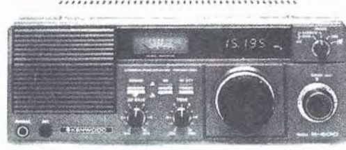
Récepteur R600. Prix : 3500 F Couverture générale 200 kHz à 30 MHz.
