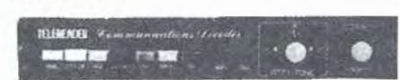
TELEREADER - CD 660. Prix : 3605 F. Nouveau décodeur pour réception en CW, RTTY (Baudot & ASCII) et AMTOR (mode FEQ/ARQ).
