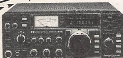
▲ IC 745 transceiver décimétrique couverture générale a la réception 12 V-200 W Prix : 10874 F option télécommande Prix : 746 F
