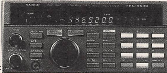
FRG 9600. Prix : 5060 F ▲ Récepteur scanner de 60 MHz à 905 MHz, tous modes, 100 mémoires, 13,8 V. Option interface APPLE II.
