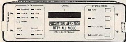
**POCOM - AFR 2000.** Nouveau décodeur automatique RTTY : Baudot et ASCII - TOR (ARQ/FEQ). Affichage sur écran vidéo et sortie RS 232C.
