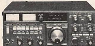
**YAESU - FT 980.** Transceiver décimétrique couverture générale de 150 kHz à 30 MHz en réception, émission bandes amateurs. Tous modes. 120 W HF. Tout transistor. Alimentation 220 V. Option interface de télécommande pour Apple II.
