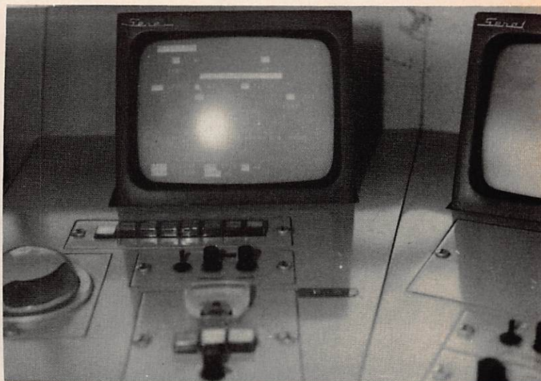
Ecran de contrôle permettant la vérification des plans de vol avant l'établissement des strips.
