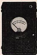
Très beau contrôleur, toujours en service dans l'armée US - Continu 20000 Ω volt de 0 à 5000 V et de 250 µA à 10 A - Alternatif 1000 Ω/volt de 0 à 1000 V - Ohmmètre 5 gammes de 0 à 10 Megohms - Avec notice - Coffret alu coulé de 28 x 18 x 11 cm avec couvercle - Poids 6 kg, Prix **285 F**
