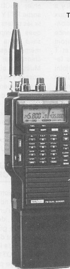
TH 75 E Talky Walky bi-bande (144, 430 MHz), full duplex - 1,5 W sur chaque bande. 5 W avec alimentation 12 V - 10 mémoires multifonctions (fréquence, offset, pas...) par bande. Squelchs séparés, réglage de balance entre les deux voies. Possède toutes les fonctions d'un transceiver mobile tel le TM 721 E plus un économiseur de batterie.
