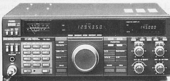
TRANSCIVER TS 790 E VHF / UHF (SHF en option) / 45 W en VHF, 40 W en UHF et 10 W en SHF
