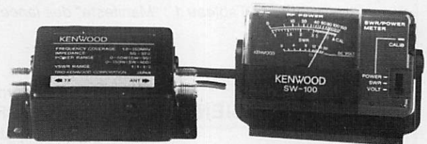
SW 100 A/B TOS-METRE induite à 150 MHz (SW 100 A) 140 à 450 MHz (SW 100 B)
