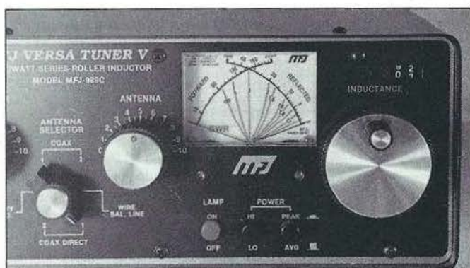
La partie droite de la face avant de la boîte de couplage MFJ. Remarquez le gros bouton à manivelle, très commode d'emploi, ainsi que le compteur de tours au-dessus.
