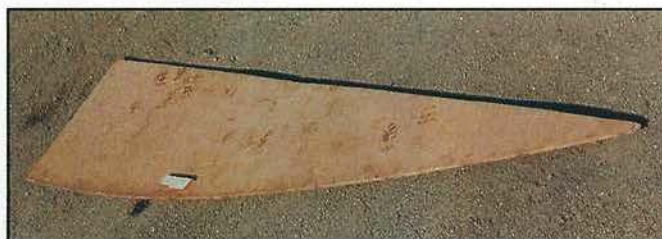
Le gabarit ayant servi à la mise en forme des tubes.
