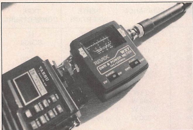
Un TOSmètre de chez REVELX, le W27, plus spécialement conçu pour les portables.
