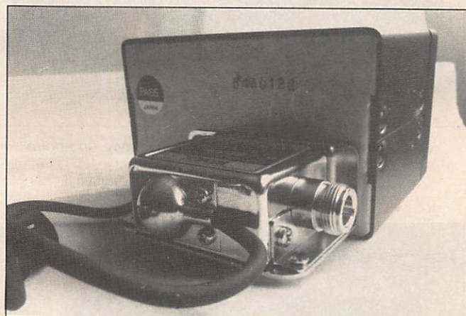
... et la face arrière avec son bloc de mesure et ses sorties sur prises de type "N".
