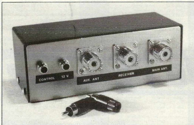
A l'arrière, les prises "antennes".
