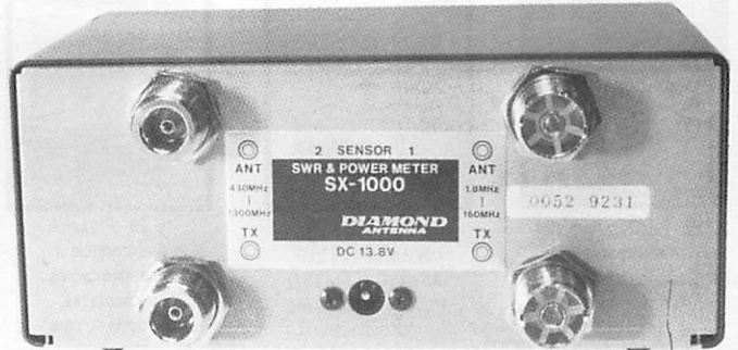
Les prises sur la face arrière.
