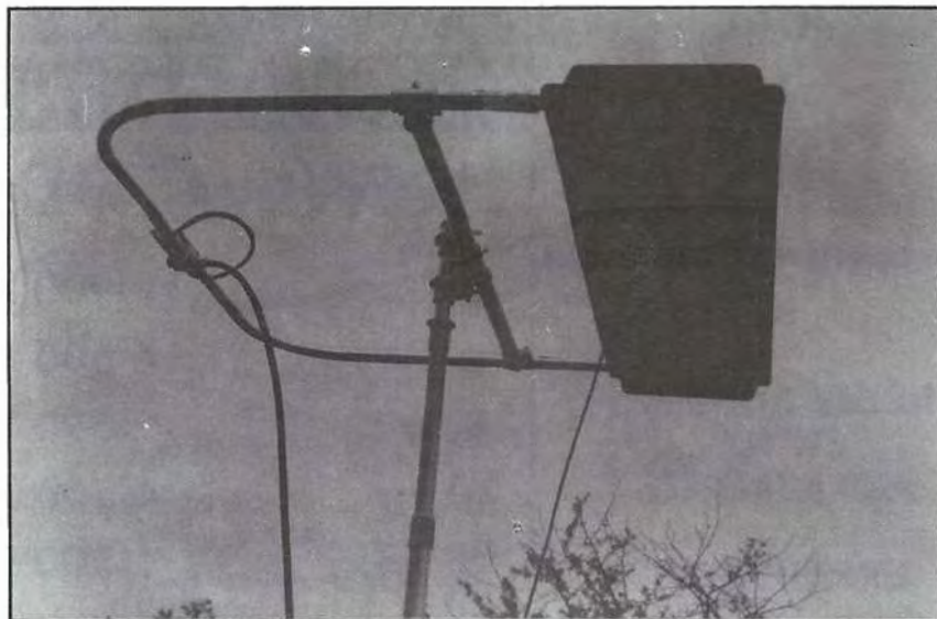
L'antenne Isoloop en montage horizontal.
