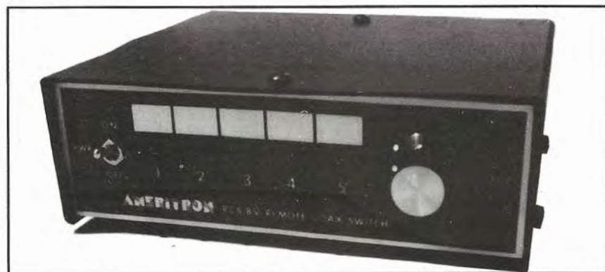
Le boîtier de commande. De gauche à droite : mise en route, LED indiquant l'antenne utilisée, contacteur.
