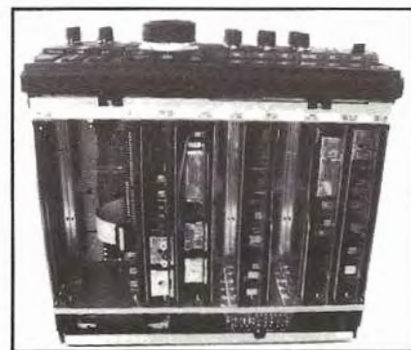
Le NRD-535 vu de dessus. De haut en bas : le compartiment frontal, le bac à cartes enfichables et le compartiment arrière.
