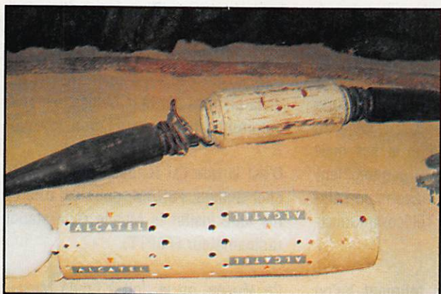
Un câble sous-marin et son répéteur.
