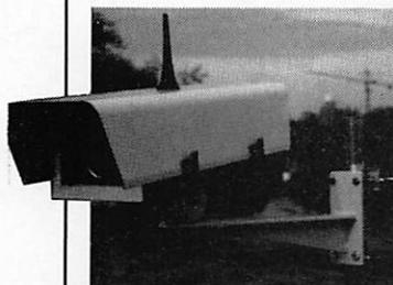
**CE 1200** : Caisson extérieur comprenant caméra CCD. Emetteur 2 W, 1200 MHz, antenne OMNI.
