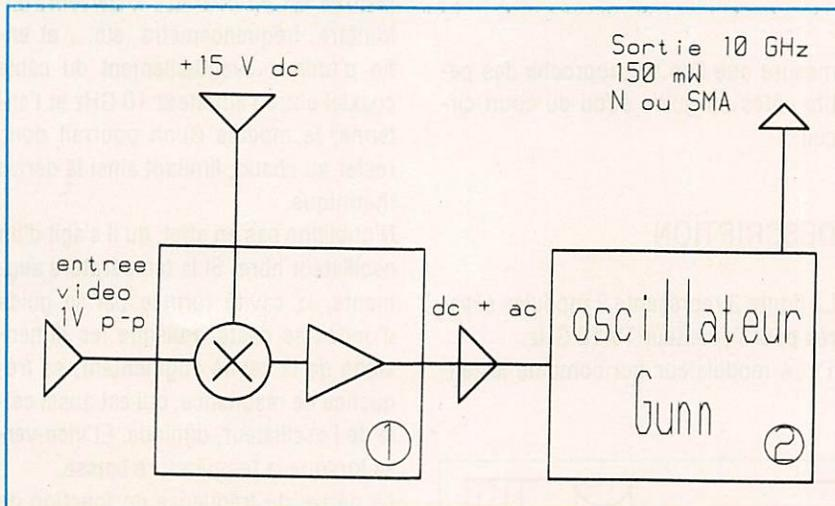
Figure 3 : en 1 le modulateur, en 2 l'oscillateur.
