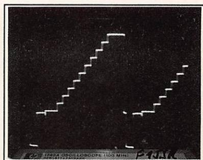
Photo C) Voici l'allure du signal fourni par notre émetteur à 10,4 GHz lorsqu'on lui applique le signal vidéo en escalier. Le pic tout à gauche représente le top de synchronisation. Les dix pics très
