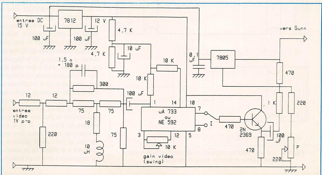
Figure 4 : Schéma du modulateur.
