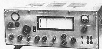
**RÉCEPTEUR DE TRAFIC AME 7G-1680.** Superhétérodyne à double changement de fréquence, couvre de 1,7 à 40 MHz en 7 gammes, sensibilité 1 µV - BFO puissant et très stable pour recevoir la BLU - S/mètre et HP incorporés. Alim. secteur 110/220 V. Dimensions : 400 x 800 x 300 mm. Poids : 65 kg. Livré en parfait état de fonctionnement avec sa notice technique. Prix .....2500,00 F
