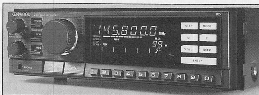
Le Kenwood RZ-1, avec un look d'auto-radio haut de gamme, couvre de 500 kHz à 905 MHz mais sans la BLU.
