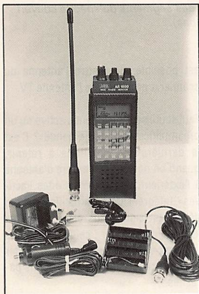
Un bon compromis : l'AOR AR-1500 est un scanner portatif offrant 1000 mémoires et la possibilité d'écouter la BLU. De plus, il est livré avec de nombreux accessoires.
