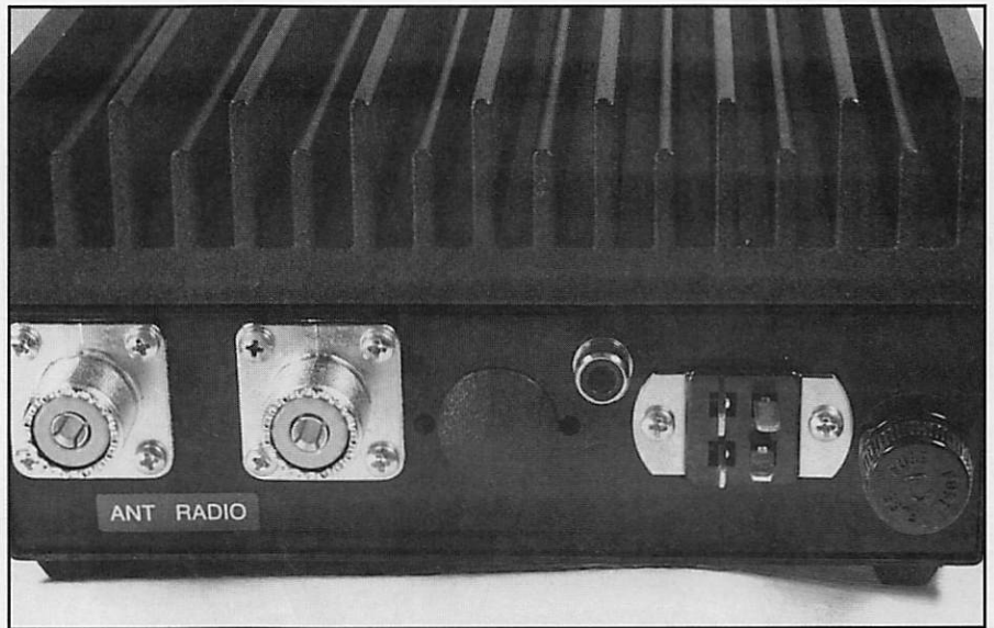
Face arrière avec prises SO-239 notez le connecteur d'alimentation "spécial"
