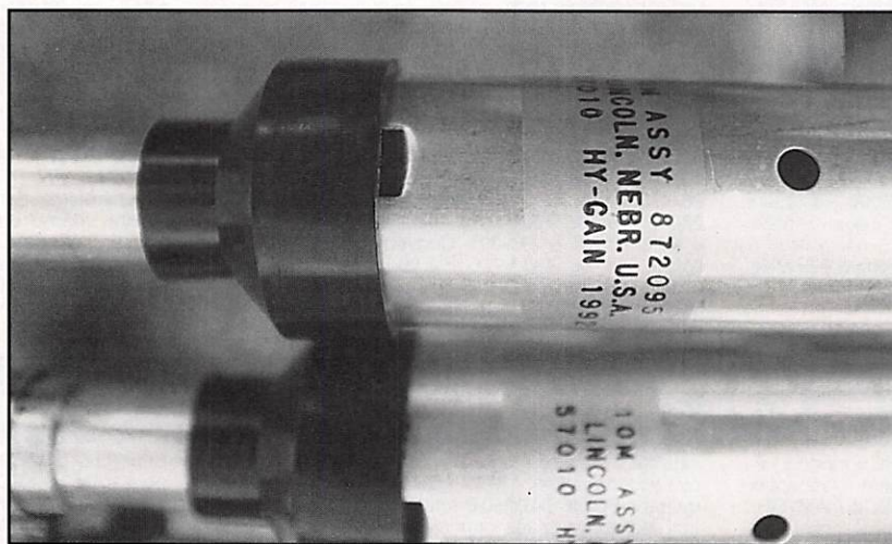
Le repère des bobines. Seule la référence chiffrée (872095) permet de repérer la bonne self. Comme sur toutes les antennes les trous seront toujours vers le bas pour éliminer l'humidité.
