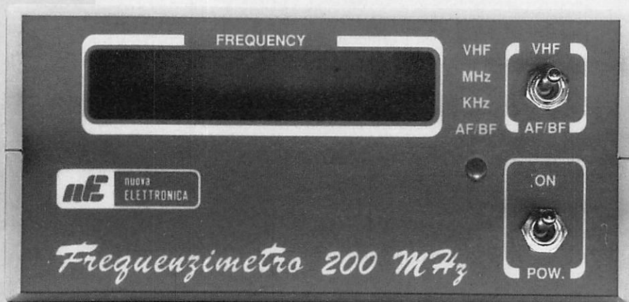
Photo 1. La face avant du fréquencemètre terminé.
