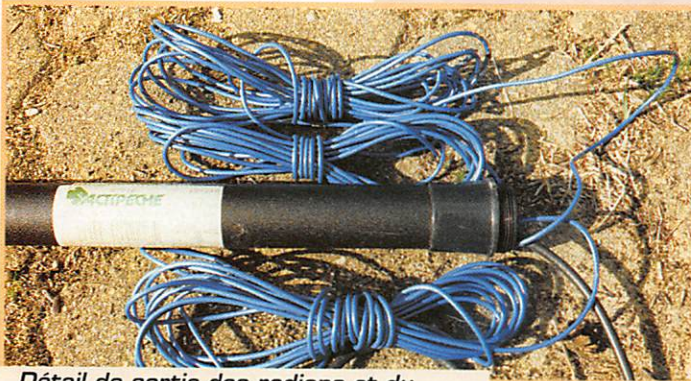
Détail de sortie des radiaux et du coaxial.
