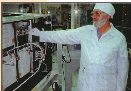
Lou, W5DID montre les relais d'antennes VHF/UHF de P3D. L'émetteur 2m est placé juste sous sa main.
