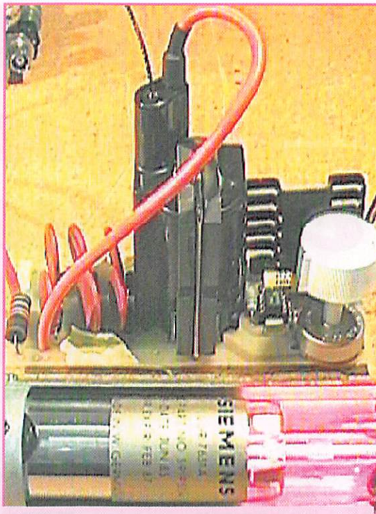
Photo 5 : Le montage vu de profil avec le laser en fonction. La lumière visible dans le tube n'est PAS de la lumière laser et ne présente aucun danger. C'est du faisceau laser généré aux extrémités qu'il faut se méfier.
