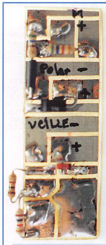
Platine de sécurité vue côté soudures et composants. Le thyristor n'est soudé que lorsque cette platine est mise en place.
