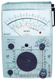
GI 83 - Millivoltmètre analogique CHAUVIN-ARNOUX
