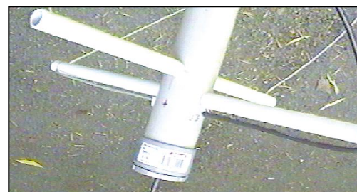
Figure 4 : L'antenne hélice quadrifilaire se compose de deux boucles perpendiculaires, entortillées de 180 degrés (une demi-spire).
