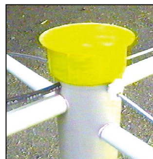
Figure 7 : Connexions du haut de l'antenne (vue de dessus). La moitié de la grande boucle est obligatoirement réalisée en coax. Les trois autres brins peuvent être en coax court-circuité ou en fil métallique.
