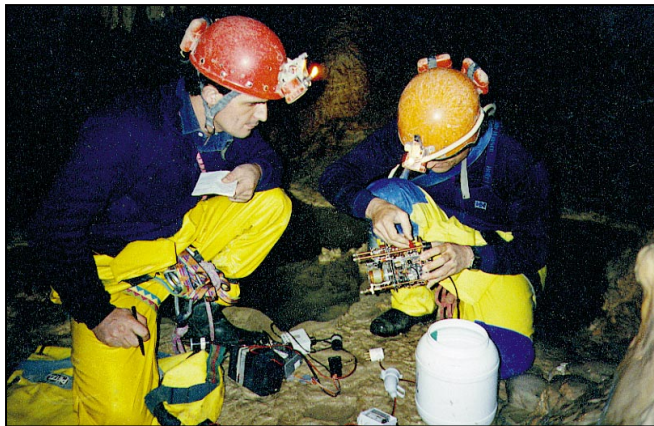
300 mètres sous terre, F6FPB Jean-Jacques et F10VB réparant le poste de radio 1,8 MHz construit par F6IDE Jean-Jacques, dans un bidon étanche.
