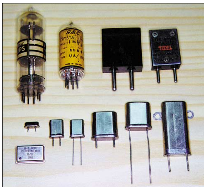
Figure 2 - Divers types de boîtiers de quartz.
