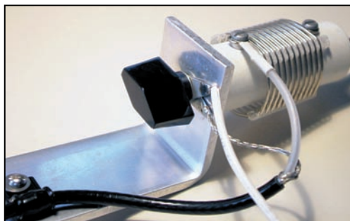
Montage du câble et du contrepois.
