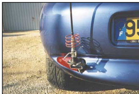
Photo 6 : L'antenne déca ART66 Eco.
