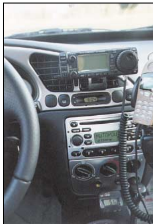
Photo 1.1 : Montre l'installation des supports sans perçage. Ici, utilisation du support universel pour le téléphone.
