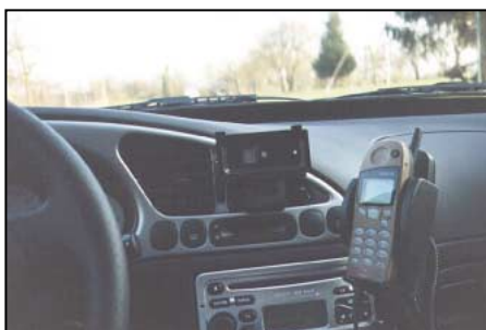
Photo 2 : Montre le support aluminium fabriqué sur lequel est fixée la plaque de verrouillage pour l'IC-706.
