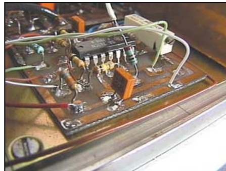
Photo 7 - Module fixé par collage.
