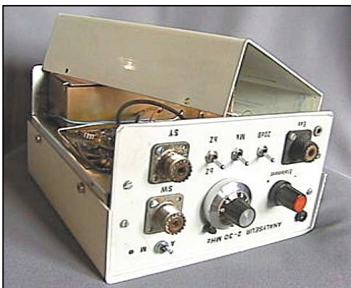
Photo 3 - Coffret formé de deux U en tôle.
