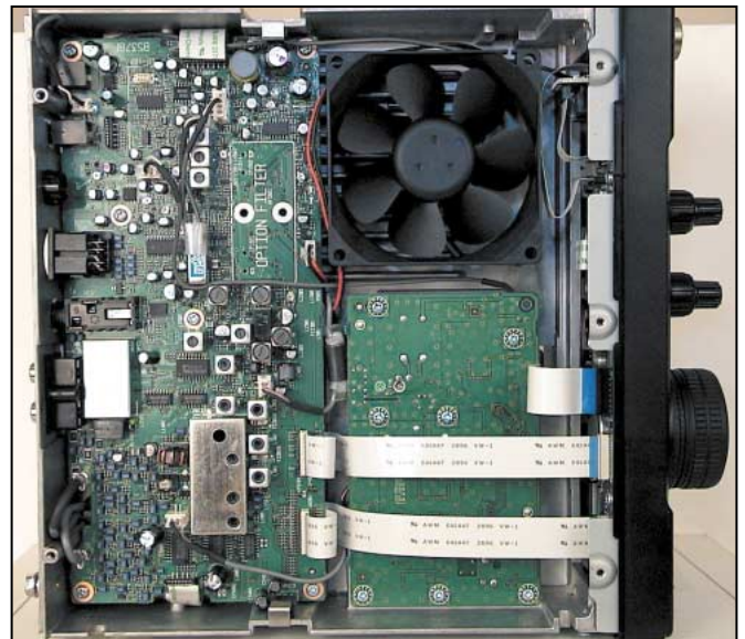
Un gros ventilateur assez discret évacue les calories.
