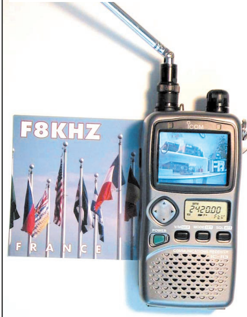
L'IC-R3 en réception type ATV (essai local sur 2420 MHz).
