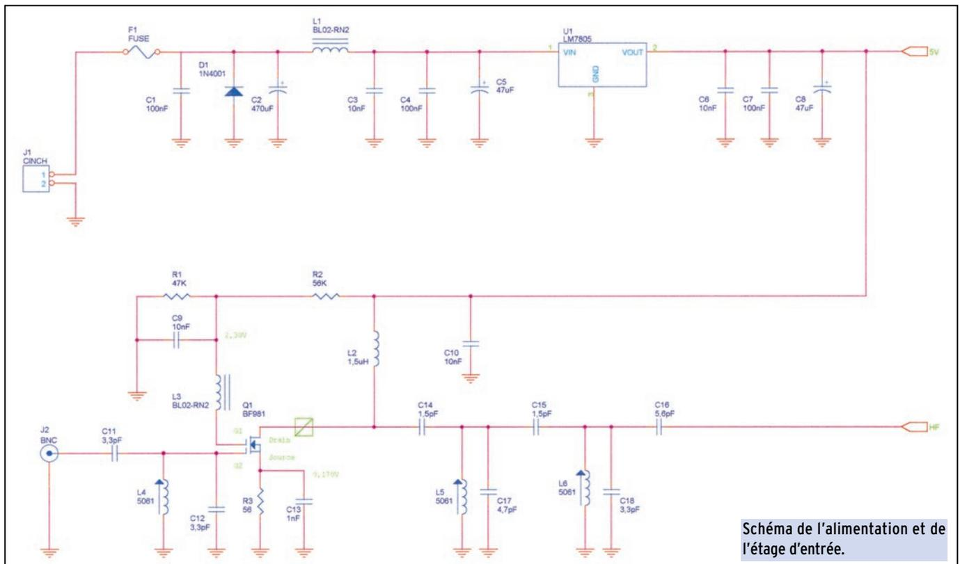
Schéma de l'alimentation et de l'étage d'entrée.
