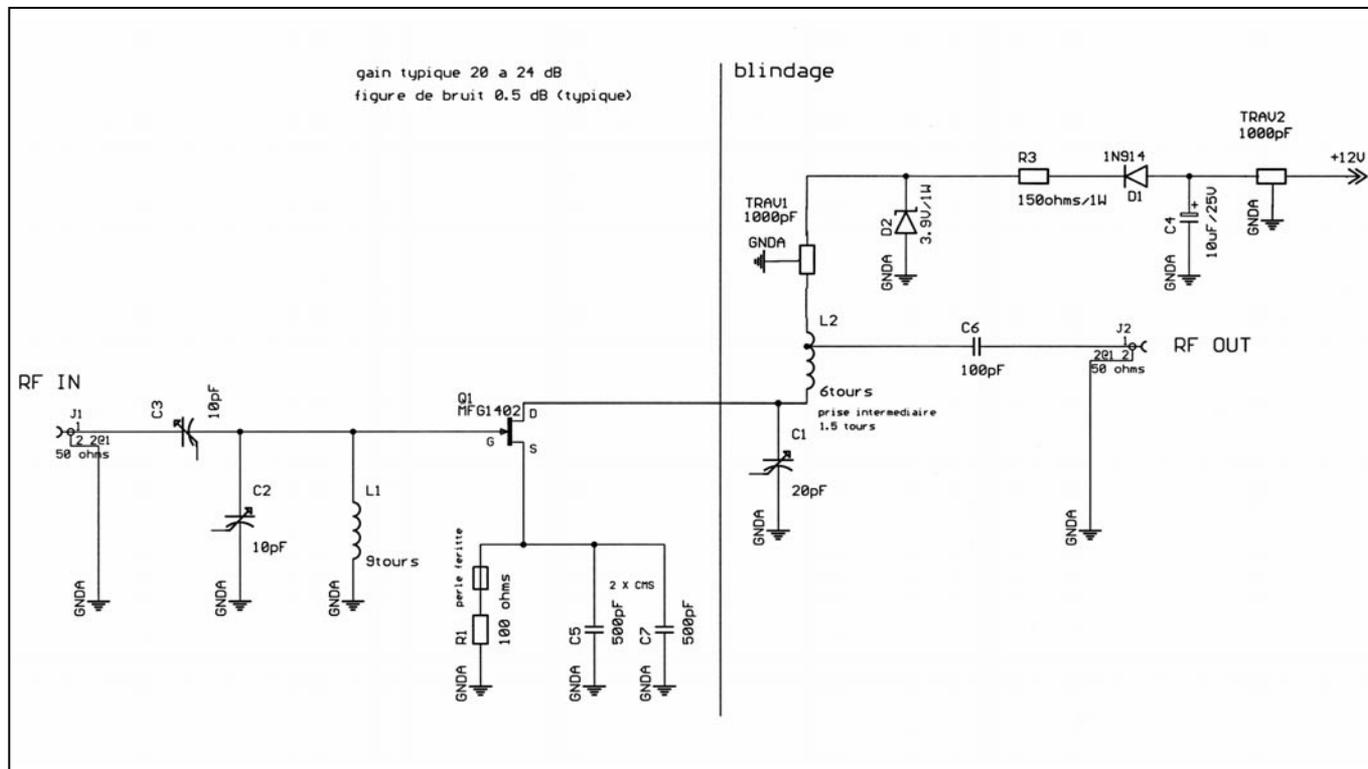
Figure 1: Ce schéma est dérivé d'une application décrite dans l'ARRL Handbook.
