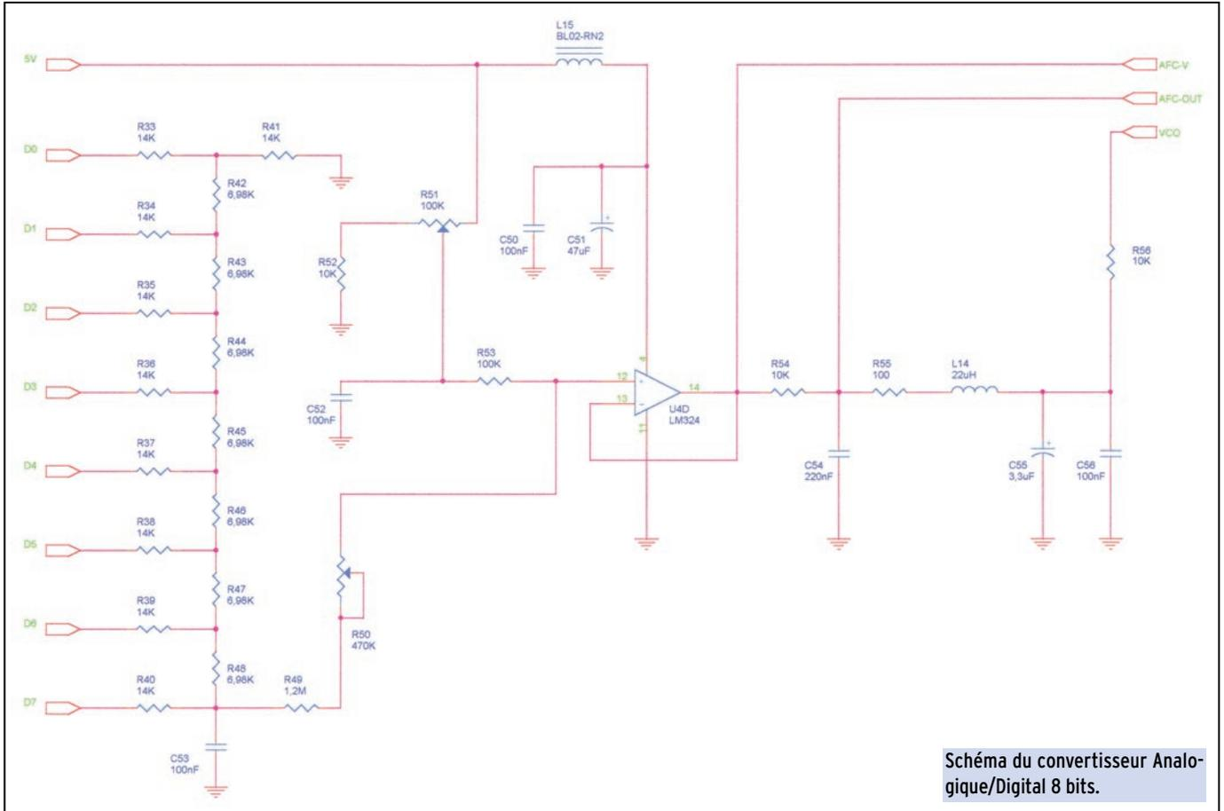
Schéma du convertisseur Analogique/Digital 8 bits.
