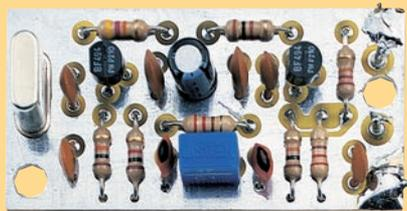
Amplificateur HF conçu pour le 3,5 ou le 7MHz et en mesure de délivrer une puissance d'environ 1 watt sur une charge de 50 ohms.
