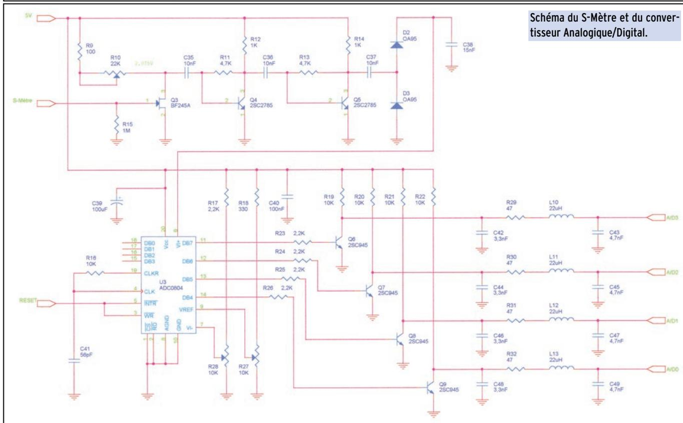
Schéma du S-Mètre et du convertisseur Analogique/Digital.
