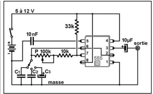
Figure 7 : Schéma du générateur BF à signaux carrés.
