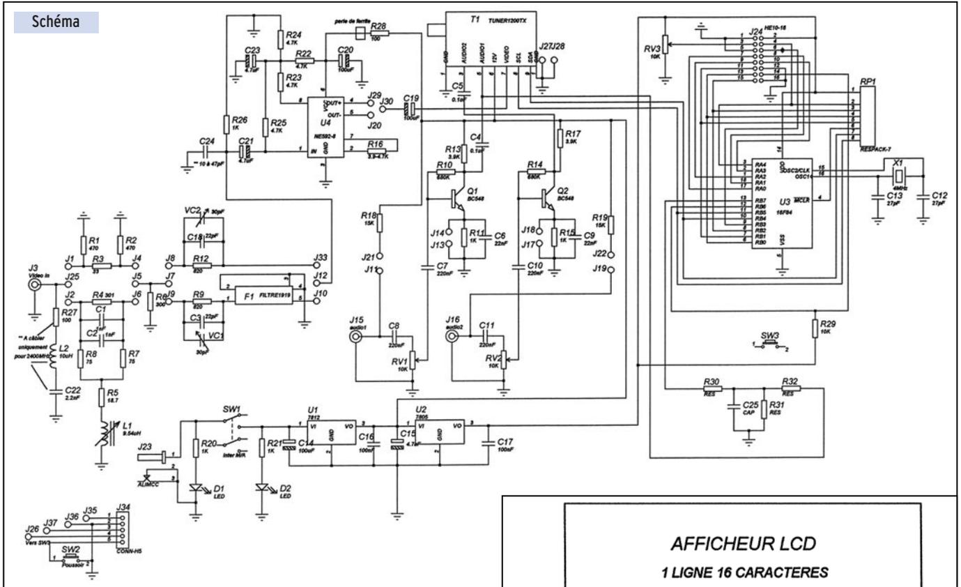
C'est ainsi qu'il faut câbler R27, L2, C22 sur les platines 2400. Le potentiomètre de niveau vidéo (excursion) se trouve dans le module. Le régler une fois pour toutes.
