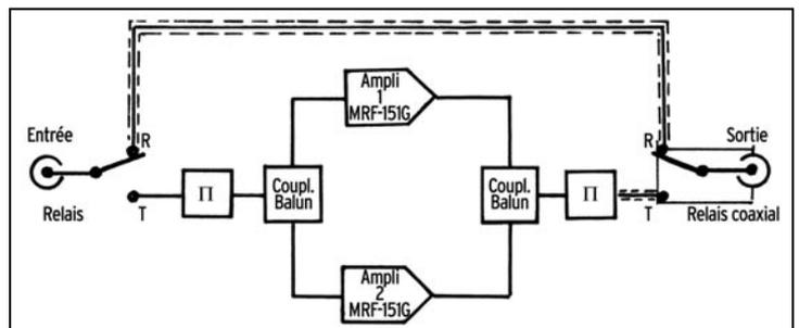
Figure 2 : Schéma synoptique de la partie HF.
