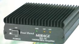
**BD-35 Mirage** Amplificateur linéaire VHF/UHF. Sortie 30 à 45 W (VHF) et 16 à 35 W (UHF) pour 1 à 7 W d'excitation (conçu pour utilisation avec TX portatifs). Sélection automatique de bande. Commutation automatique émission/réception. Fonction full-duplex. Connecteurs uniques en entrée et en sortie pour raccordement d'émetteurs et d'antennes bi-bandes. Protection contre les inversions de polarité.
