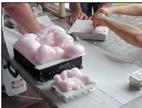
Protection de modules par mousse polyuréthane.
