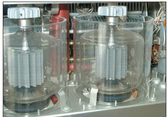
Vue intérieure du Drake L4B, les tubes dans leur cheminée.
