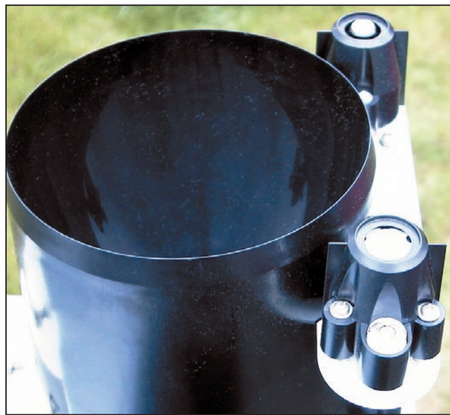
Le pluviomètre et les capteurs solaires.
