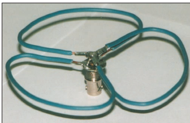
La Big Wheel au complet. On voit le stub d'adaptation et la rondelle de masse.
